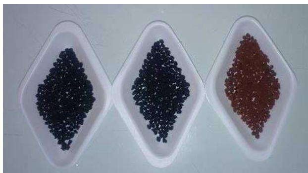
Figure IV.23. Photographies (de gauche à droite) de : CA Merck neuf, catalyseur Fe_2O_3/M neuf et CA Merck après OCVH- H_2O_2 en présence de fer ajouté en solution.
