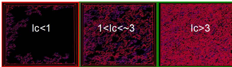
FIGURE 4.7.2 – Visualisation des 3 états de connectivité en 2D : seuls les amas connectés aux conditions aux limites (les faces) sont représentés
