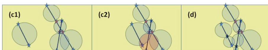
(b) Tant que l'un des points intermédiaires appartient à un cercle de diamètre 2 des points intermédiaires consécutifs appartenant à une trace, un nouveau point est ajouté selon le théorème de Koebe configuration c2-d (cercle rouge).
