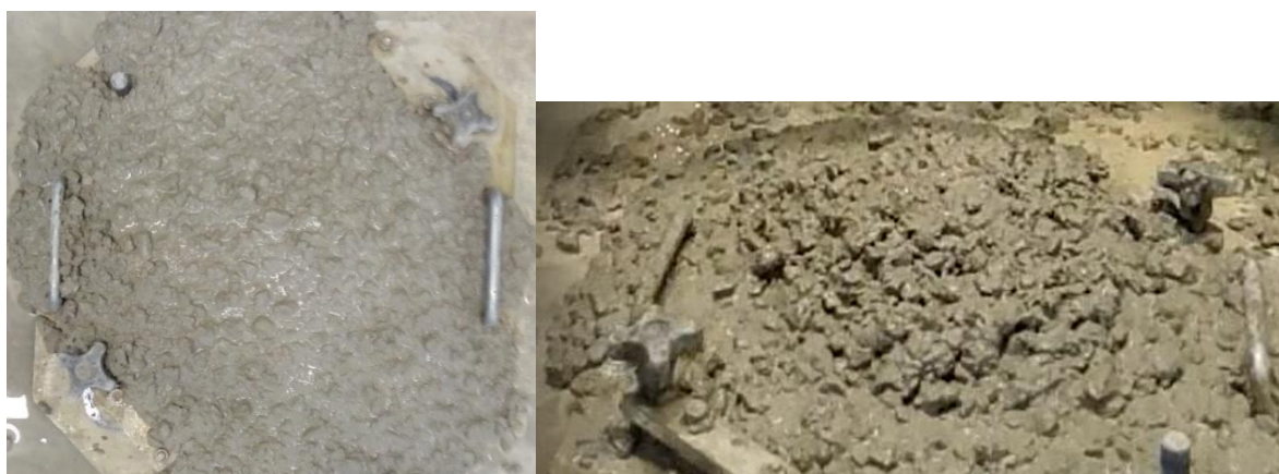
Figure 3.17 À gauche : Affaissement du béton Op300. À droite : Béton Op200 après essai d'écoulement au cône inversé
