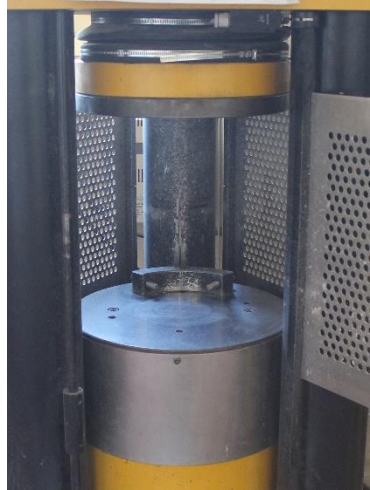
Figure 2.55 Machine d'essai de résistance à la compression pour les éprouvettes de béton
