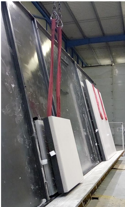
Figure 2.72 À gauche, opération de retournement de la première paroi ; à droite, descente de la première paroi vers la seconde
