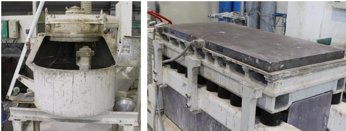
Figure 2.54 Matériel utilisé pour la confection des éprouvettes (malaxeur à gauche et table vibrante à droite)
