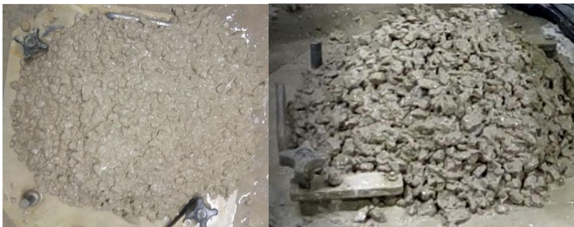
Figure 3.16 À gauche : affaissement au cône d'Abrams du béton No300. À droite : Béton No200 après essai d'écoulement au cône inversé
