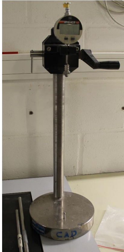
Figure 2.58 Matériel utilisé pour la mesure des variations dimensionnelles des éprouvettes de béton
