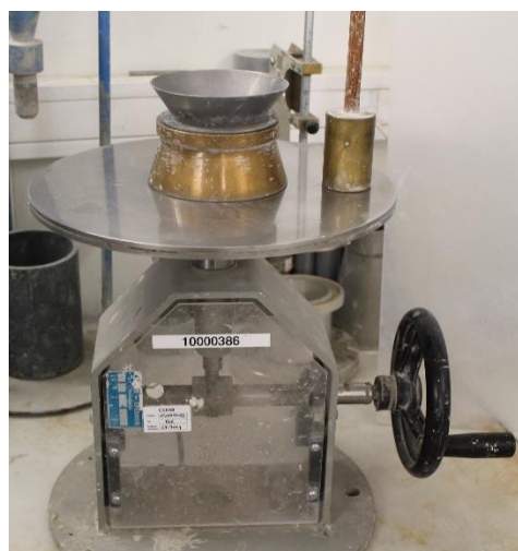
Figure 2.31 Matériel utilisé pour mesurer l'étalement des mortiers
