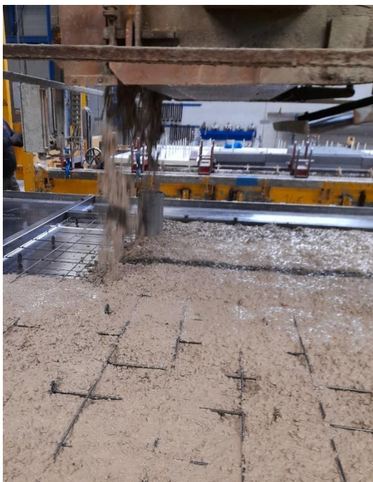
Figure 2.71 À gauche, coulage du béton au sein du moule à l'aide de la trémie ; à droite, vis sans fin permettant d'entraîner le béton frais hors de la trémie
