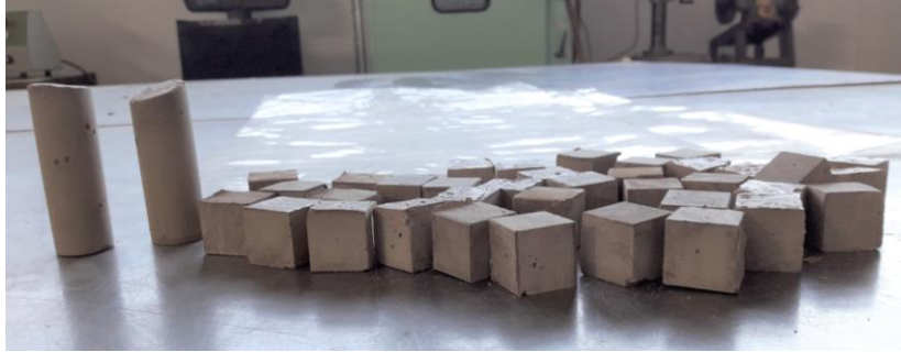
Figure 2.40 Éprouvettes de pâtes cimentaires réalisées pour l'étude de la microstructure
