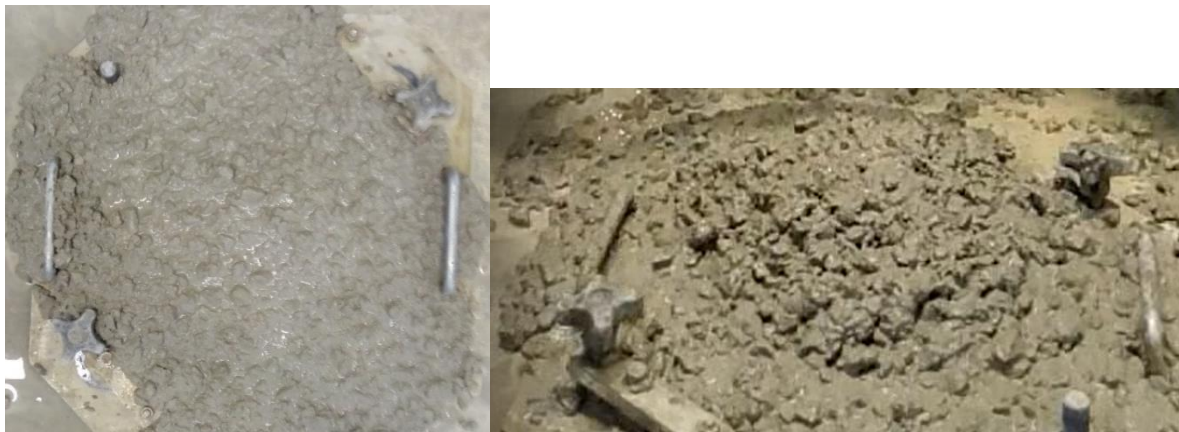
Figure 3.17 À gauche : Affaissement du béton Op300. À droite : Béton Op200 après essai d'écoulement au cône inverse
