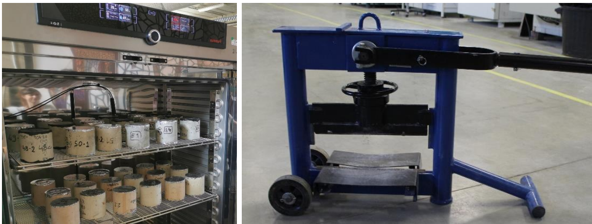
Figure 2.61 Enceinte de carbonatation et appareil de fendage utilisés
