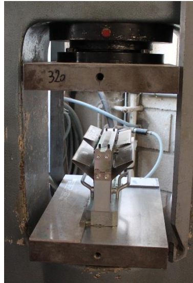
Figure 2.56 Machine d'essai de résistance à la traction par fendage pour les éprouvettes de béton
