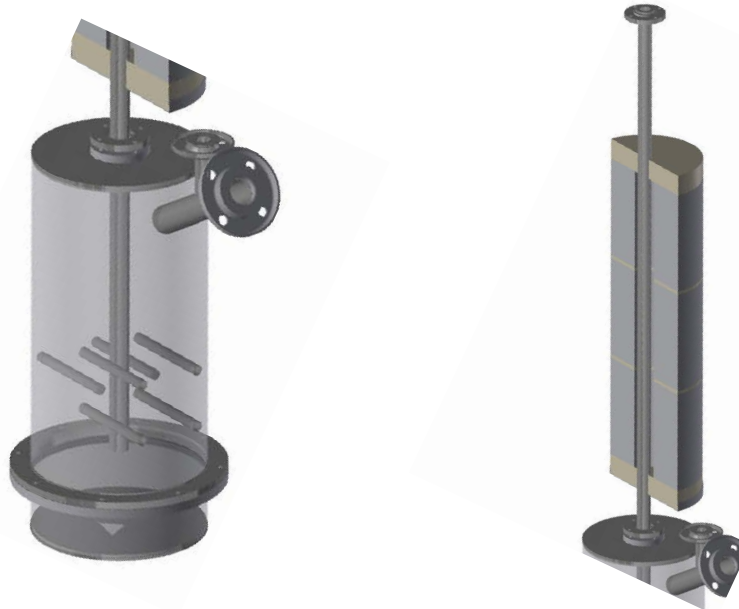
(a) Représentation 3D de l'emplacement des thermoplongeurs. (b) Coupe 3D des modules de puissance (fours).
