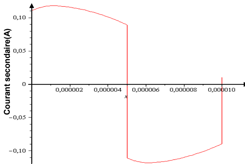
Figure 3.5 Impact de l'inductance magnétisante sur la forme d'onde du courant secondaire
