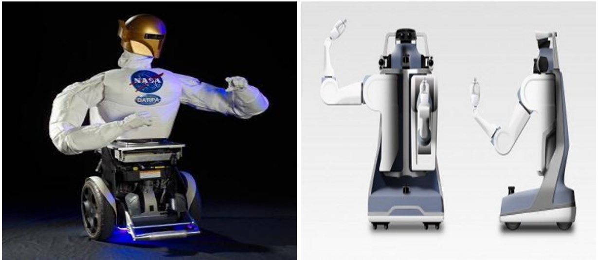
Figure 2: Robonaut, construit par Dextrous Robotics Laboratory , est un humanoïde conçu pour travailler avec des astronautes (à gauche), Le robot PR2 est une plateforme dédiée à la recherche (à droite)
