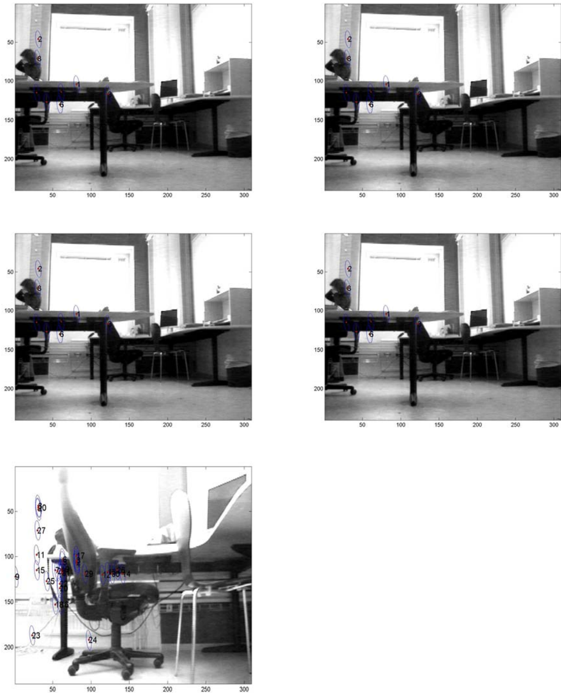
Figure 4.5: Résultats d'estimation de la position des patches des descripteurs pour une scène intérieure
