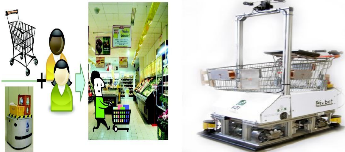
Figure 3: Contexte du projet COMMROB : développement d'un chariot de supermarché (à gauche), le robot développé par le groupe FZI à Karlsruhe (Allemagne): Interactive Behaviour Operated Trolley (INBOT) (à droite)
