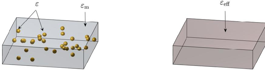
FIGURE III.1 – Représentation schématique de l'idée d'homogénéisation des approches de type milieu effectif.
