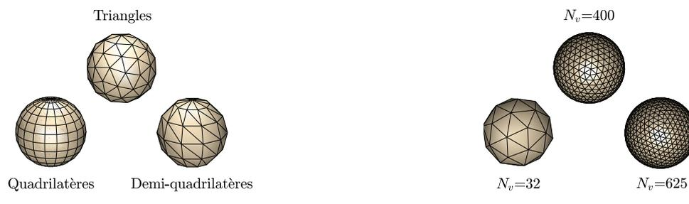
FIGURE II.14 – Illustration de la discrétisation des interfaces sous MNPBEM. À gauche, les différentes formes de facettes possibles. À droite, des pavages plus ou moins fins. Tout cela est paramétrable assez simplement sous MNPBEM.
