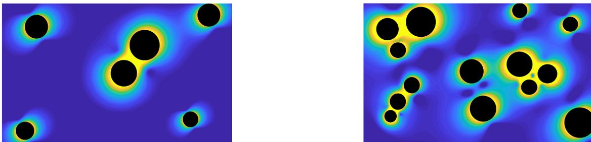
FIGURE III.3 – Illustration des effets des interactions pour des assemblées plus ou moins diluées. Cartographie de la norme du champ électrique total (simulations grâce à MNPBEM). On observe principalement des interactions entre deux particules à gauche, des corrélations entre trois particules et plus apparaissent à droite.
