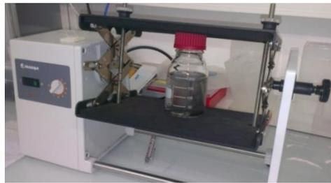
Figure 23 : Photographie du dispositif expérimental pour l'étude des cinétiques d'adsorption (agitateur rotatif Heidolph Reax<sup>®</sup>).
