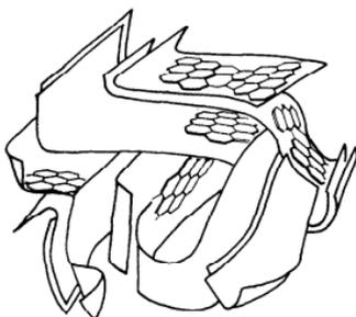
Figure 10 : Représentation schématique de la structure des charbons actifs (Stoeckli, 1990).
