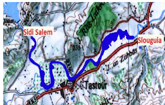
Figure 3.27 : Carte d'inondation de la moyenne vallée de la Medjerda, crue 2003, TELEMAC 2D
