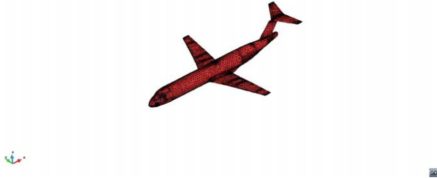
FIGURE 3.15 – Maillage du modèle simplifié d'un Fokker 100
