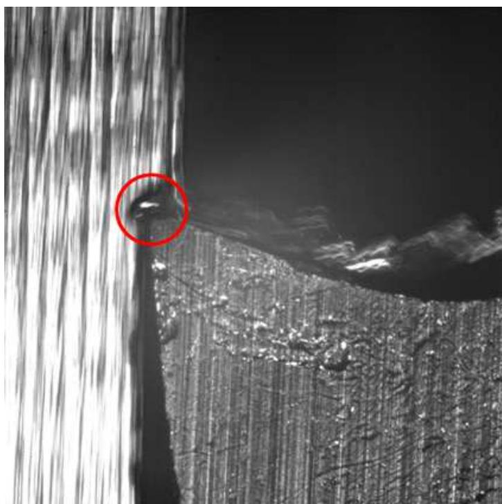
FIGURE 3.2.5 – Zone morte observée lors des usinages
