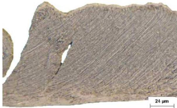
FIGURE 2.4.19 – Copeau continu pour  $V_c = 50 \text{ m} \cdot \text{min}^{-1}$  et  $f = 0.07 \text{ mm} \cdot \text{tr}^{-1}$ - cas du TA6V  $\alpha\beta$  traité transus  $\beta$
