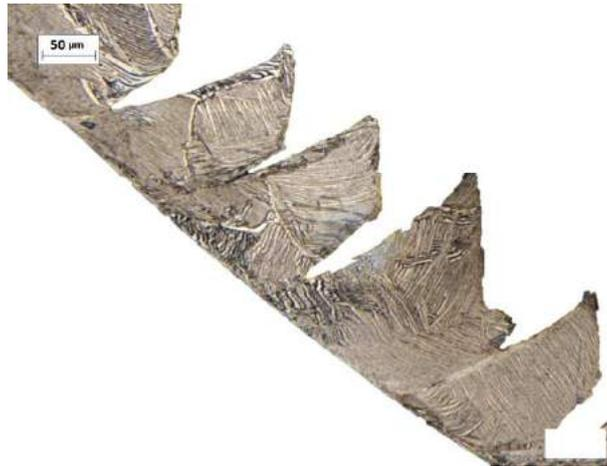
FIGURE 2.4.24 – Morphologie du copeau pour  $V_c = 65 \text{ m} \cdot \text{min}^{-1}$  et  $f = 0.16 \text{ mm} \cdot \text{tr}^{-1}$  - cas du TA6V  $\alpha\beta$  traité transus  $\beta$
