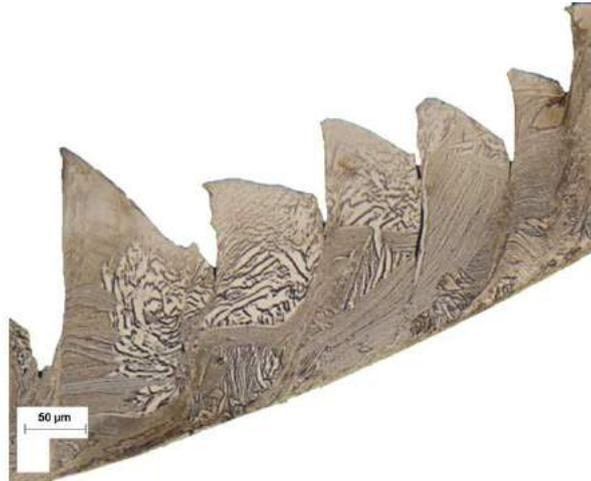
FIGURE 2.4.25 – Morphologie du copeau pour  $V_c = 65 \text{ m} \cdot \text{min}^{-1}$  et  $f = 0.19 \text{ mm} \cdot \text{tr}^{-1}$  - cas du TA6V  $\alpha\beta$  traité transus  $\beta$
