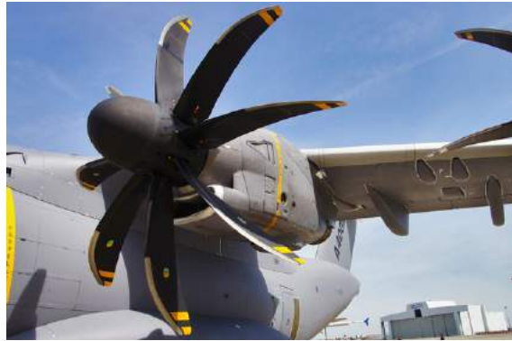
FIGURE 1.2 : Le turbopropulseur TP-400 utilisé dans la propulsion de l'Airbus 400M.
