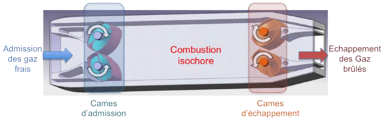
FIGURE 2.2 : Schéma du concept Thermoreacteur (brevet de Michel Aguilar [41])
