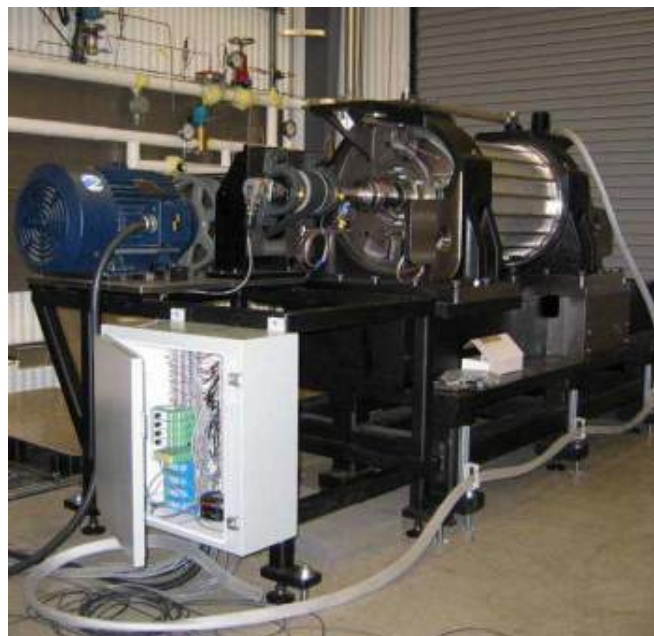
FIGURE 1.11 : Wave rotor étudié à l'université de Purdue [20] - Vue du banc expérimental.
