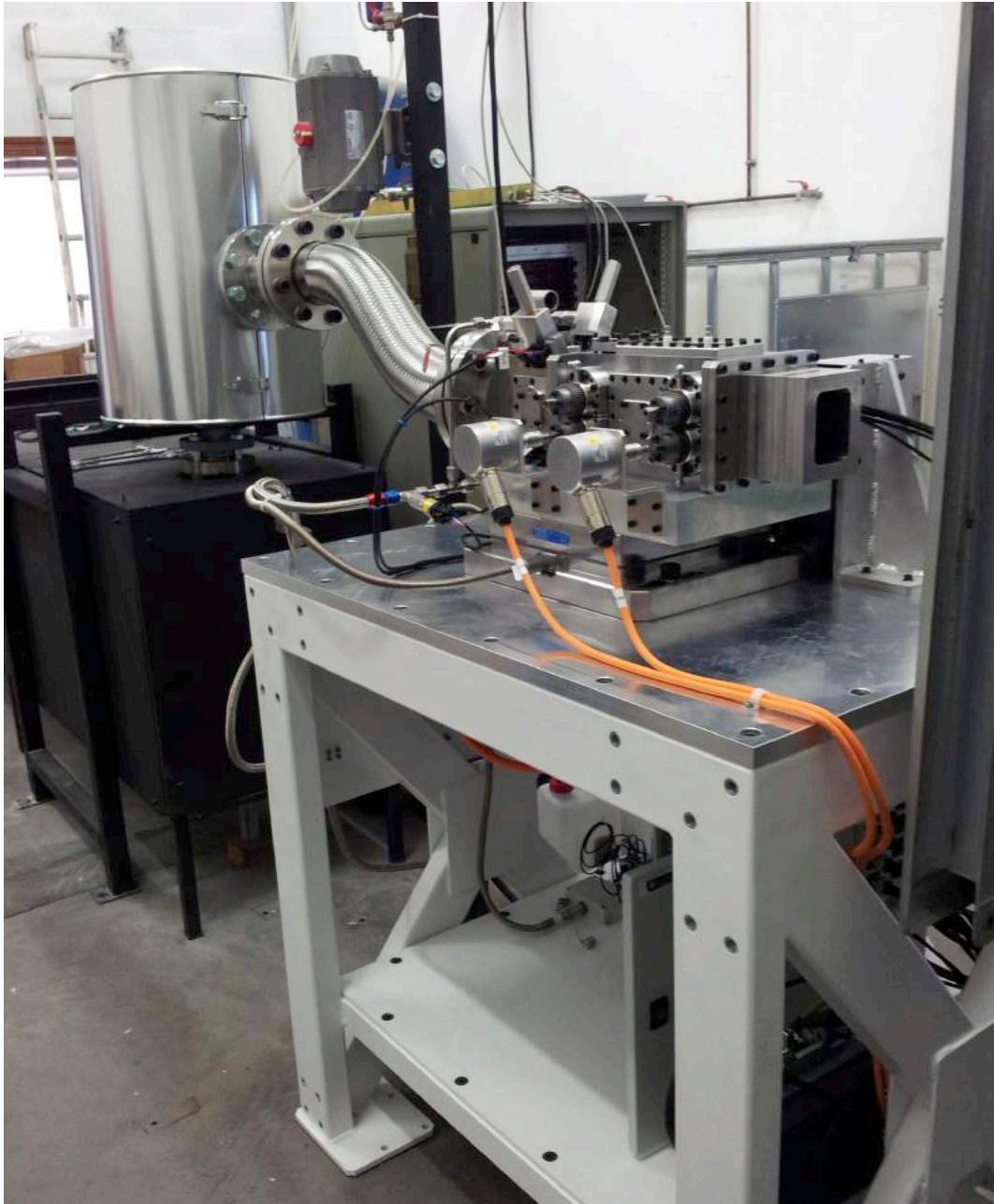
FIGURE 2.7 : Vue d'ensemble du banc thermoréacteur monté au laboratoire Pprime. Vue du réservoir d'air comprimé alimentant le thermoréacteur. L'échappement a lieu à l'air libre vers la cheminée située à droite de l'image.
