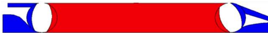
FIGURE 2.4 : Cycle CVC : phase de combustion. Les cames d'admission et d'échappement sont fermées.
