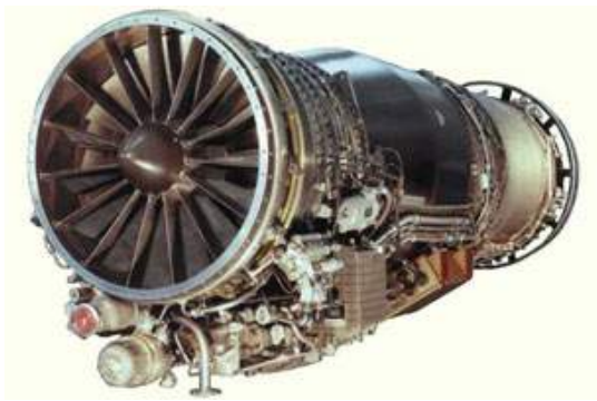
FIGURE 1.1 : Le turbo réacteur M88 utilisé dans la propulsion du Rafale.
