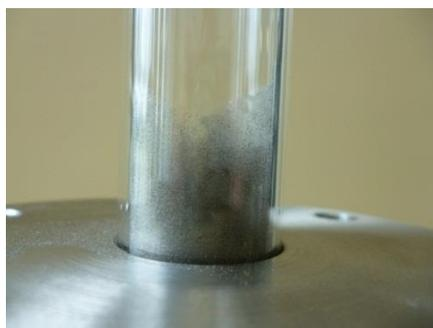
**Figure 52 :** Particules de tungstène collées aux parois de la colonne en verre de 2 cm de diamètre.
