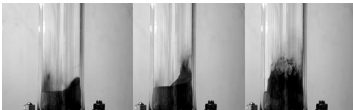
Figure 54 : Illustration de la fluidisation de la poudre de tungstène pour U_g/U_{mf} = 2,66 (Colonne de 5 cm de diamètre en verre, 1500 g de poudre)
