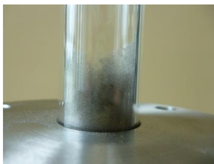
Figure 52 : Particules de tungstène collées aux parois de la colonne en verre de 2 cm de diamètre.
