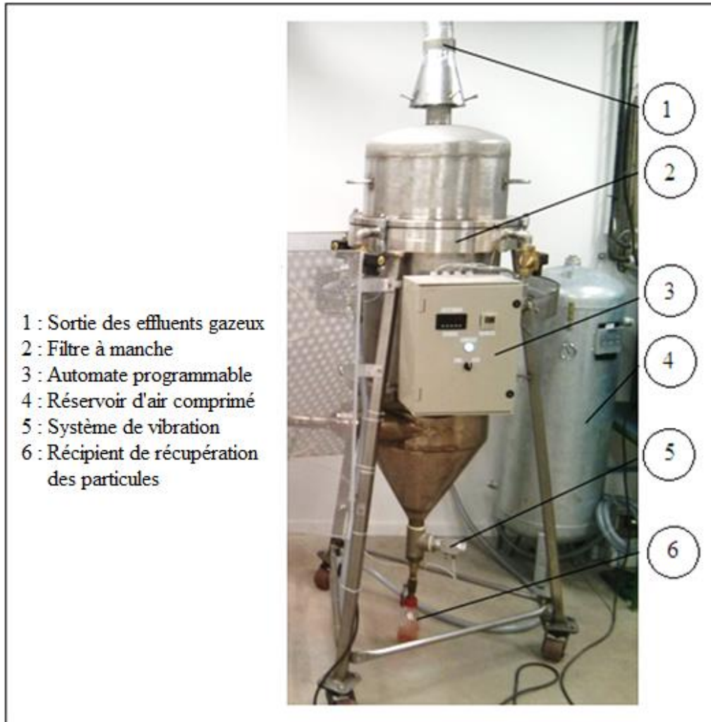
Figure 2.9 : Photo du filtre à manche.
