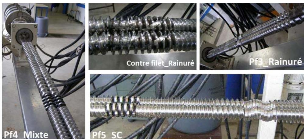
Figure II.2-12 : profils de vis utilisés en configuration contacteur-imprégnateur
