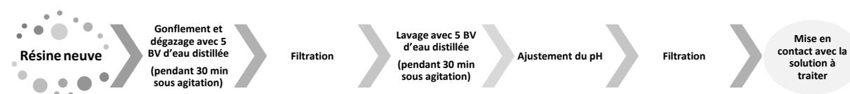
Figure II.3-3 : conditionnement d'une résine
