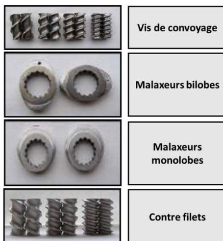
Figure II.2-3 : éléments de vis utilisés sur l'extrudeuse bi-vis Clextral BC 45
