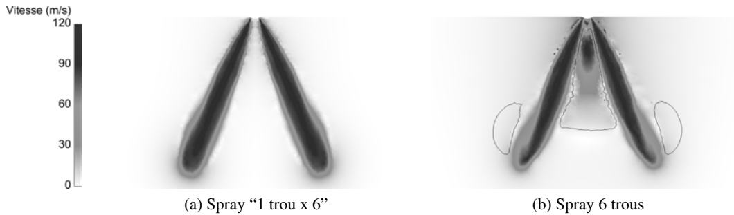
FIGURE 7.17 – Comparaison du champ de vitesse gazeuse entre le spray “1 trou x 6” (a) et 6 trous (b), au temps t=0,31 ms.
