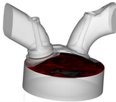
FIGURE 13.36 – Visualisation du plan de coupe horizontal sous la bougie où est analysé le champ de richesse.
