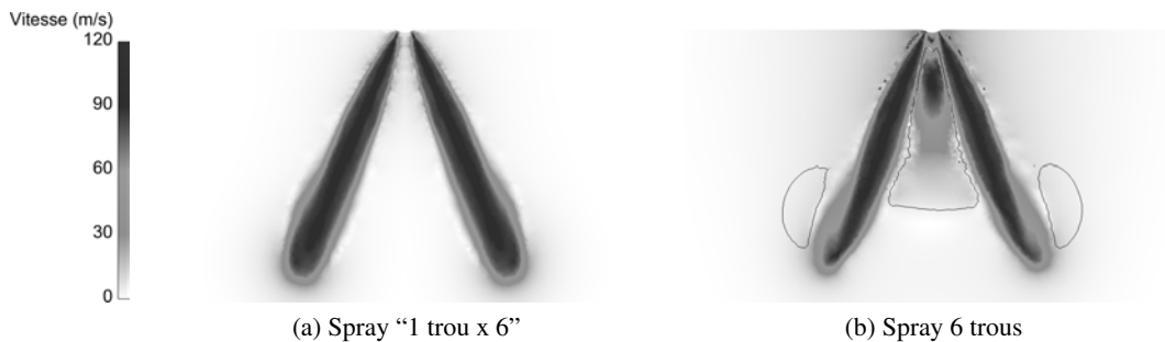
FIGURE 7.17 – Comparaison du champ de vitesse gazeuse entre le spray “1 trou x 6” (a) et 6 trous (b), au temps t=0,31 ms.
