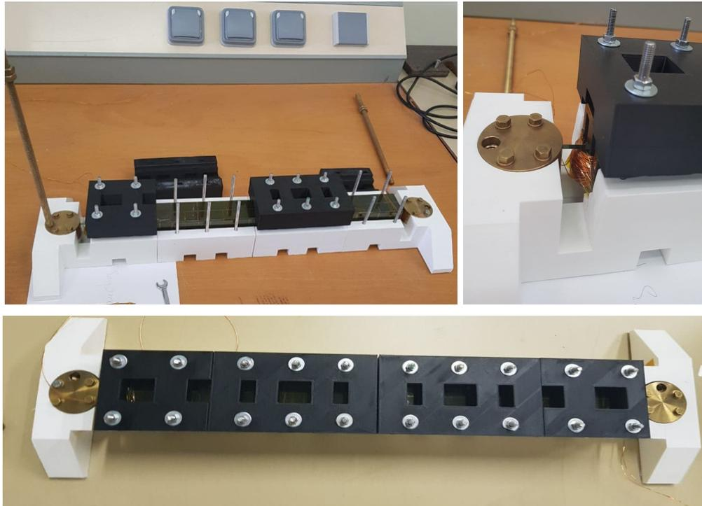
FIGURE 4.18 – Vue détaillée de l'inducteur avec le support 3D.
