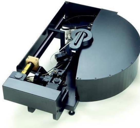
Figure 13 : Goniomètre compact ALV / CGS-3
