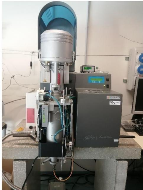
**Figure 9 :** Appareil ATG Setaram Setsys évolution 1750
