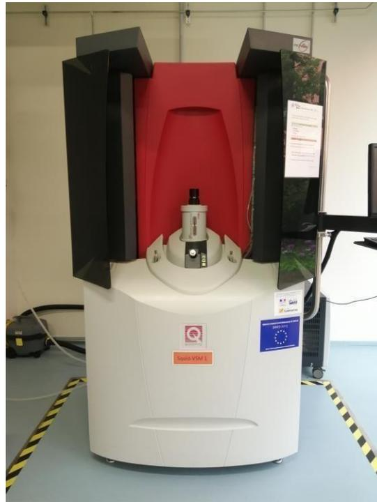
**Figure 16** : Magnétomètre MPMS3 Squid de « Quantum design ».
