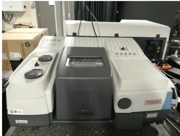
**Figure 6** : Spectrophotomètre infra-rouge à transformée de Fourier.
