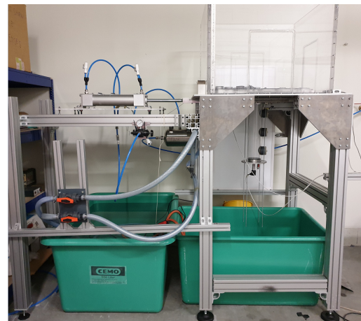
FIGURE II.2.1 – (a) Schéma de principe et (b) photo de l'installation expérimentale utilisée pour le remplissage de cylindre.
