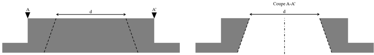
FIGURE I.2.2 – Schéma du système de diaphragme avec coupe A-A' pour visualiser le biseau. Le biseau est réalisé à 45^\circ jusqu'à d^* = 0.75 puis cet angle est adapté pour conserver une faible épaisseur jusqu'à d^* = 0.9 . Pour d^* = 1 , le diaphragme est uniquement une couronne sans biseau
