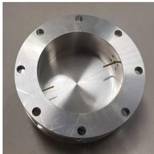
Figure 5.24 - la TGC métallique conçue pour générer le mode TE_{11} .
