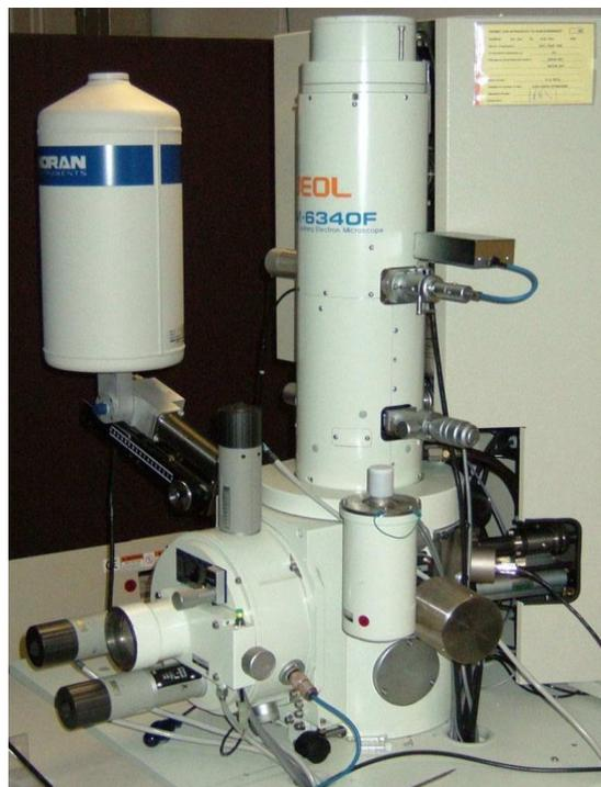
**Figure II. 11** : Microscopie électronique à balayage
