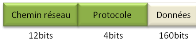
Figure II.14 PDU réseau descendant.
