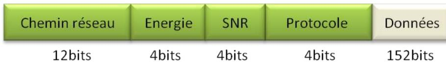
**Figure II.15 PDU réseau ascendant.**
