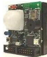
**Figure I.5 Nœud capteur de la plate-forme ScatterWeb.**
