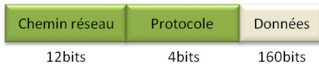
**Figure II.14 PDU réseau descendant.**
