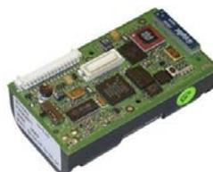
**Figure I.6 Nœud capteur BTnode.**
