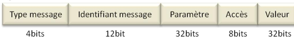
**Figure II.20** Format d'un message applicatif de réglage d'un paramètre capteur.
