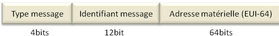
**Figure II.19** Format d'un message applicatif de découverte.
