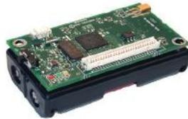
**Figure I.3 Nœud capteur Mica2 Mote.**
