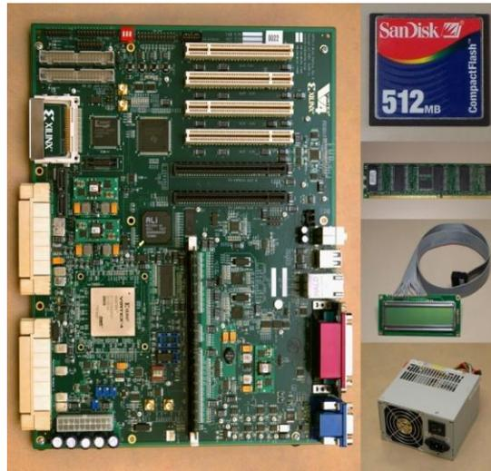
**Figure II.26 La plateforme ML410 FPGA-Xilinx.**
