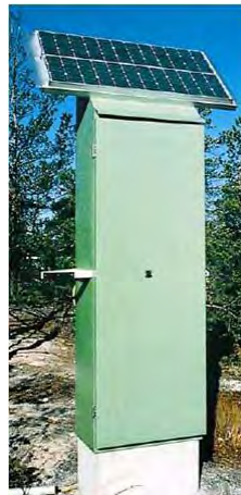
Fig 1-43 : Prototype couplant PV et pile à combustible
