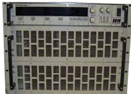
Fig 5-20: Charge électronique H&H pour l'émulation de l'électrolyseur
