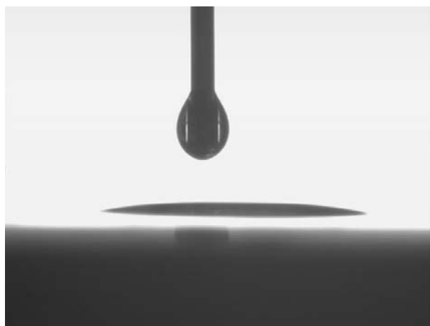
FIGURE 4.19 – Goutte de HFE7000 sur une surface en acier AISI304
