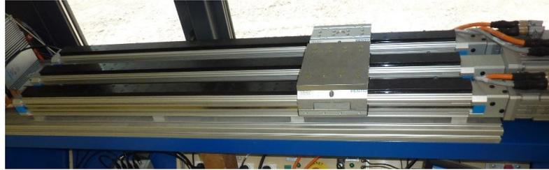
FIGURE B.3: axes à vis à billes
