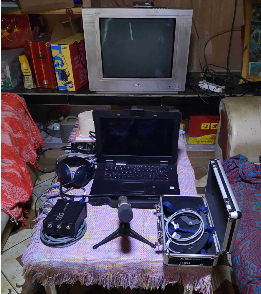
FIG. 2.1 : Vue à la première personne du dispositif d'enregistrement avec en face, à 40 cm le microphone muni de sa bonnette, à un mètre l'écran d'ordinateur sur lequel est projeté le diaporama. La télévision au fond est recouverte d'un tissu pour limiter la réverbération. L'enquêteur, assis à gauche, passe les diapositives tandis que la locutrice, assise sur un tabouret en bois décrit les diapositives proposées par l'enquêteur.
