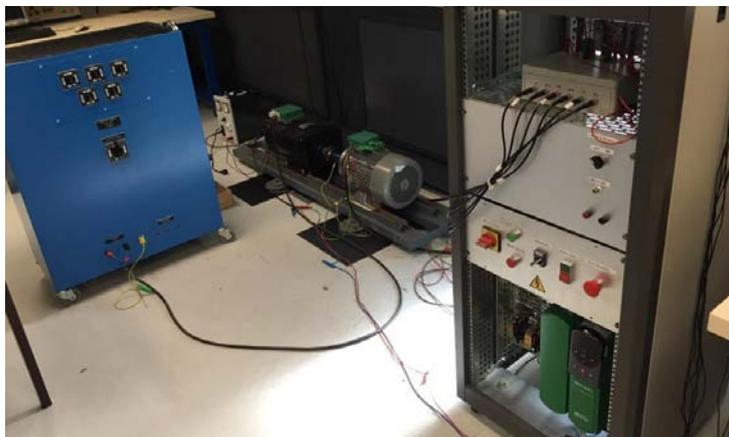
FIGURE A.1 – Banc expérimental du laboratoire LAPLACE composé d'un variateur de vitesse, d'un moteur asynchrone, d'une machine à courant continu associée à un banc de charge et d'un disque de déséquilibre.
