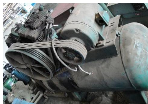
FIGURE 5.1 – Représentation schématique d'une courroie trapézoïdale (a) et système de compression entraîné par un système de transmission à 4 courroies en V (b).
