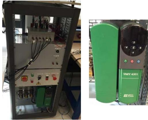
FIGURE A.2 – Variateur de vitesse Leroy Somer UMV4301 utilisé pour alimenter le moteur asynchrone (droite) et son armoire d'alimentation associée (gauche).
