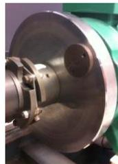
FIGURE 4.4 – Disque en acier avec la masse de déséquilibre  $m_1 = 77,5g$  attachée.
