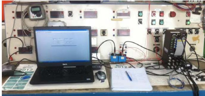
FIGURE 5.5 – Représentation du système d'acquisition (droite) et de l'ordinateur utilisé pour la configuration et la sauvegarde des mesures (gauche).
