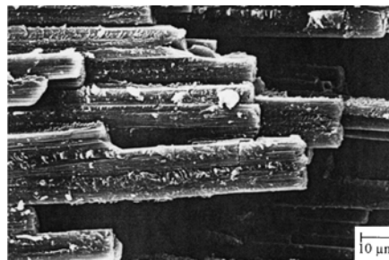
FIGURE 1.9 – Observation par fractographie de la rupture de fibres dans un stratifié en carbone-époxy (Speissberger et al. [204])
