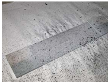
FIGURE 2.13 – Réalisation du mouchetis
