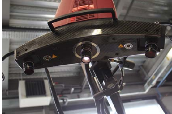
(b) système d'acquisition Aramis 3D : caméras et éclairage central
