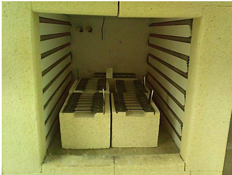
**Figure II-17 : Disposition des éprouvettes de traction avant de subir un traitement de préoxydation dans un four CARBOLITE® sur des briques réfractaires creusées au niveau de la zone utile**
