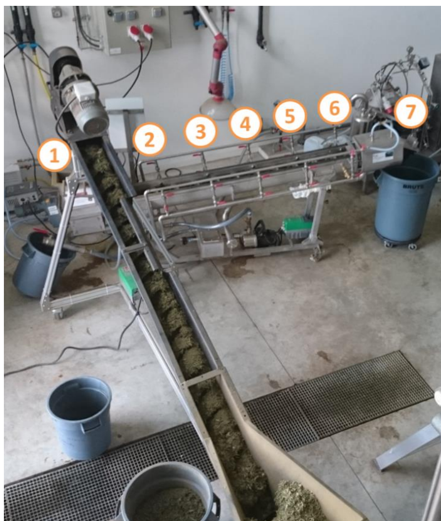
Figure IV-24 Photographie de l'extracteur pilote VHSA et de la vis d'alimentation en feuilles séchées et compactées de Stévia du Paraguay pendant l'essai de description du fonctionnement du pilote, les sphères numérotées orange représentent les différents points de prélèvements
