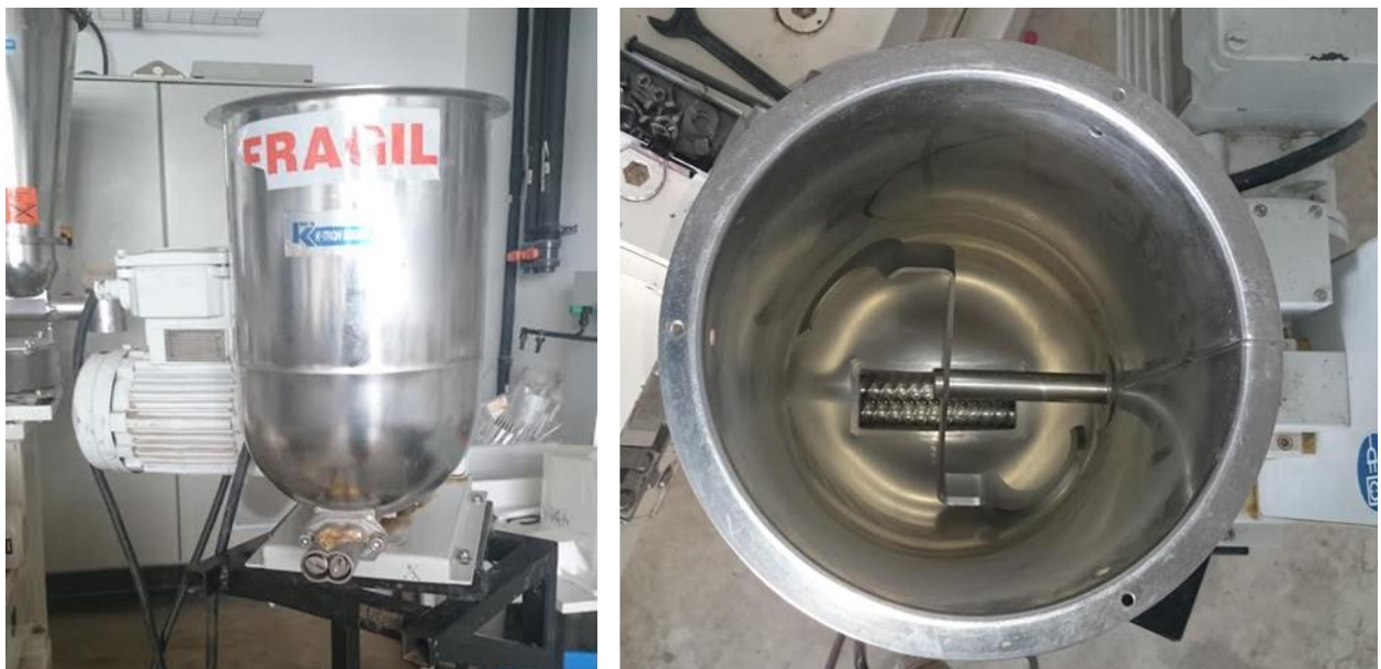
Figure III-22 Photographies de la trémie doseuse KCL-KT20
