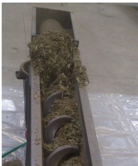
Figure IV-5 Débordement des feuilles de Stevia lors des essais de convoyage dans le compacteur à vis sans âme
