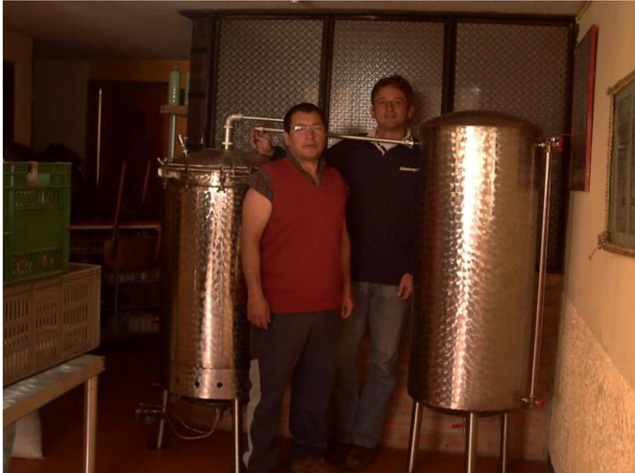
*Photo 4. Distillateur utilisé pour l'extraction des huiles essentielles et hydrolats, Miguel Abril et Yann-Olivier Hay.*
