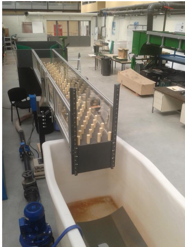
Figure II.8 : Petit canal inclinable avec macrorugosités.
