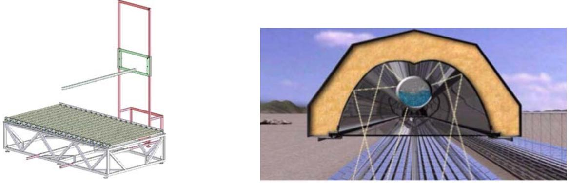
FIGURE 3.6 – A gauche : Vue CAO du prototype en construction au laboratoire Rapsodee ; à droite : image d'un CPC - Récepteur des collecteurs NOVATEC-BIOSOL
