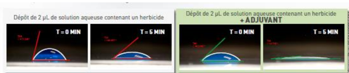
Fig. 6 : Amélioration de l'étalement de la bouillie par ajout d'un adjuvant qui réduit la tension de surface de la bouillie pulvérisée Source : Association Française des Adjuvants (AFA), édition novembre 2014.
