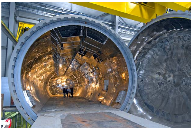
FIGURE 1.8 – Installation autoclave pour Airbus [16]
