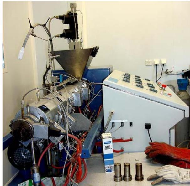
FIGURE III.1 – Photo de l'extrudeuse
