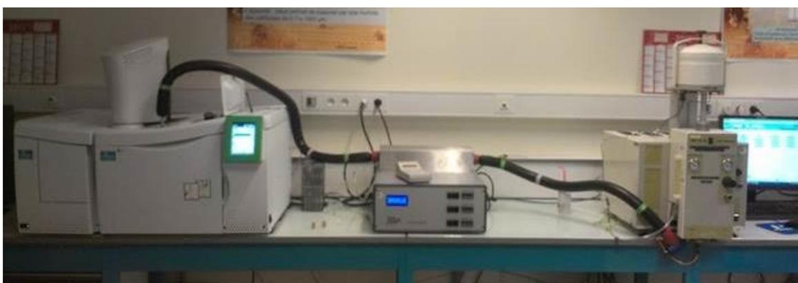
Fig. 31. TGA-GC-MS device.
