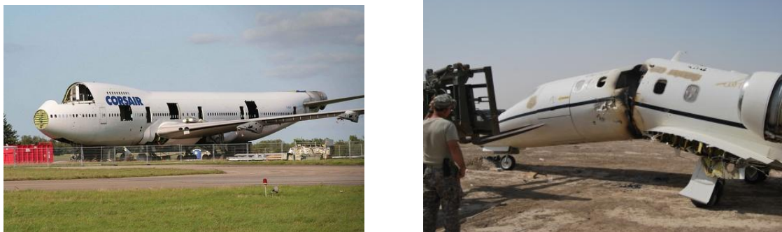
FIGURE IV.2: La déconstruction des avions.
