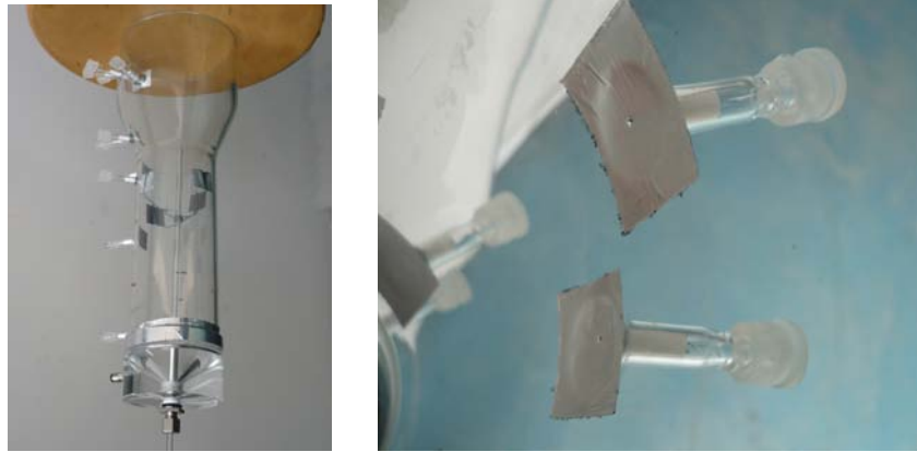
FIGURE 6.6 – A gauche, plan détaillé de la sonde à fibre optique en verre et de son centreur (a). A droite, plan détaillé des prises de pression (b).
