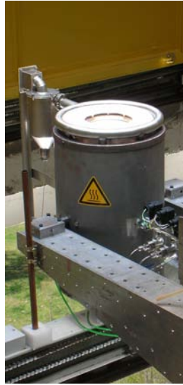
FIGURE 2.26 – Prototype de récepteur solaire en test au four solaire d’Odeillo
