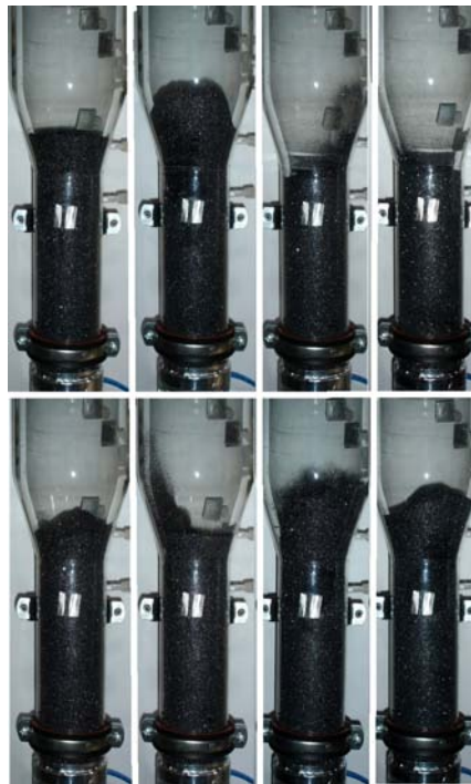
FIGURE 7.3 – Photographies du lit fluidisé expérimental en mouvement
