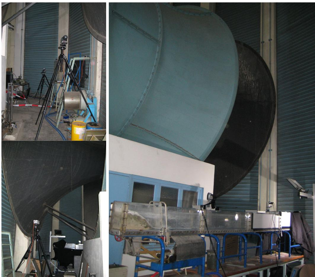
FIGURE 2.22 – Dispositif expérimental de la campagne 4 dans le bâtiment Camichel. Le convergent de la tuyère de la soufflerie est visible au dessus du canal.
