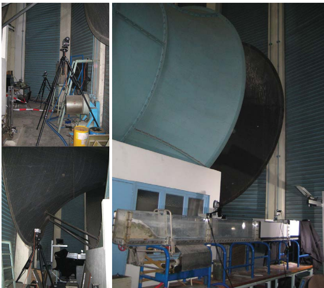
FIGURE 2.22 – Dispositif expérimental de la campagne 4 dans le bâtiment Camichel. Le convergent de la tuyère de la soufflerie est visible au dessus du canal.
