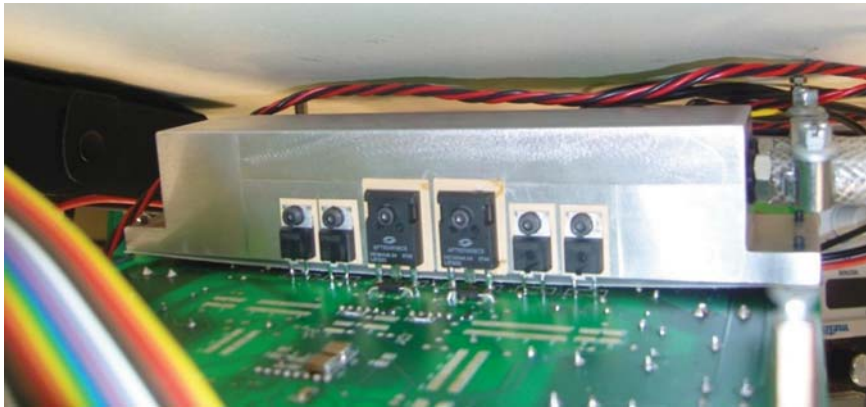
Figure 4-31 : Montage du dissipateur à eau.
