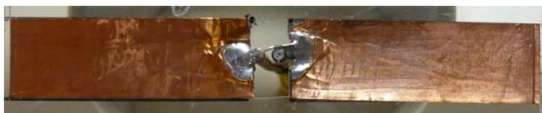
FIGURE 5.10 – Photo du dipôle à 1,17GHz
